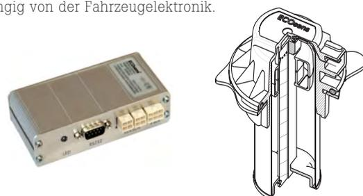
Die Schnittstellenbox versorgt die elektronischen Tanksensoren mit einer gesicherten Stromversorgung und berechnet den aktuellen Status des Fahrzeugs. Mögliche Betankungen oder Entnahmen aus den Kraftstofftanks werden automatisch erkannt und an die Schnittstelle gesendet.
